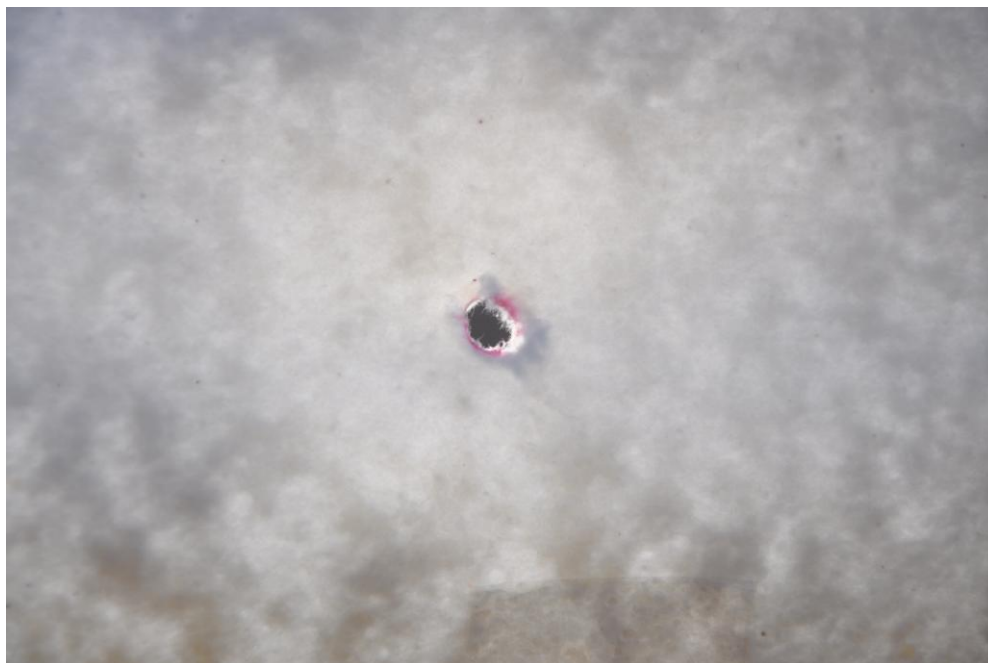
Figura 21: demonstra a presença de chumbo, através do exame de Residuograma de Chumbo, apenas nas bordas do orifício de passagem do projétil, no tiro efetuado a 100 cm do alvo, revelada pelo desenvolvimento de uma coloração violeta.
