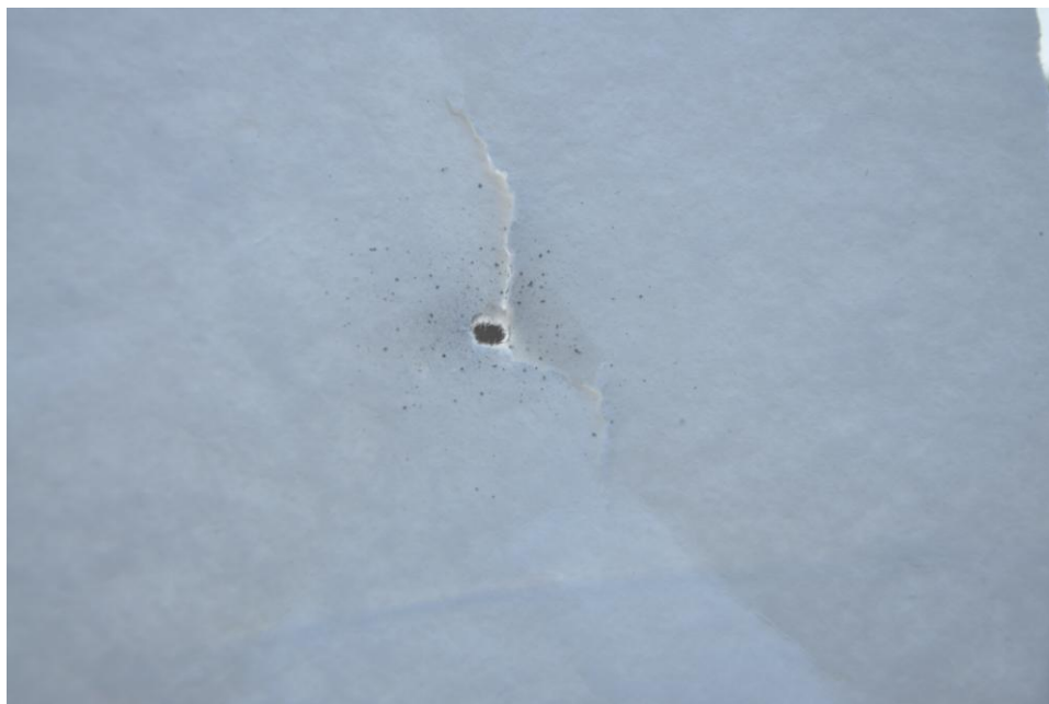
Figura 16: além do orifício causado pela passagem do projétil, rompimento do alvo resultante da ação dos gases, são perceptíveis as zonas de esfumaçamento e tatuagem causado, no último item, pela deposição forçada de partículas sólidas decorrentes da pólvora na superfície atingida pelo tiro.
