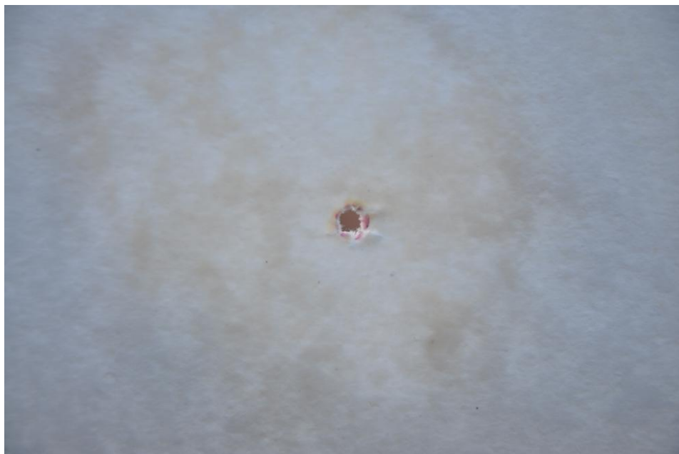
Figura 22: demonstra a presença de chumbo, através do exame de Residuograma de Chumbo, apenas nas bordas do orifício de passagem do projétil, no tiro efetuado a 100 cm do alvo, revelada pelo desenvolvimento de uma coloração violeta.
