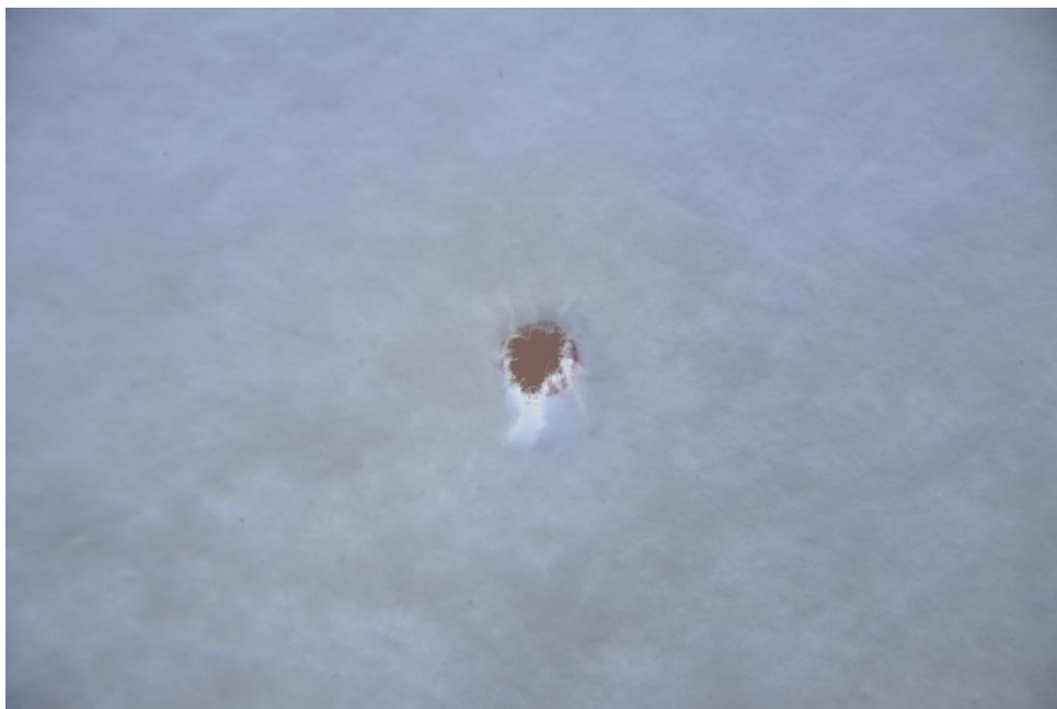
Figura 19: demonstra a presença de chumbo, através do exame de Residuograma de Chumbo, apenas nas bordas do orifício de passagem do projétil, no tiro efetuado a 50 cm do alvo, revelada pelo desenvolvimento de uma coloração violeta.
