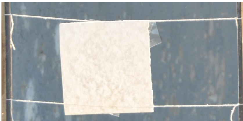
Figura 11: um dos alvos de papel de filtro qualitativo 80\text{g/m}^2 , medindo 25 \times 25\text{ cm} , usado como anteparo para realização dos tiros.
