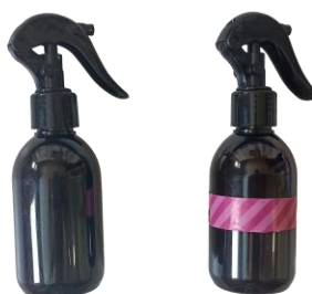
Figura 12: borrifadores usados para revelação dos resíduos de chumbo. O do lado esquerdo, contém a solução-tampão de ácido tartárico e tartarato de sódio e potássio (pH 2,8). O do lado direito, contém a solução de rodizonato de sódio 0,1%. Ambas preparados no momento do uso.
